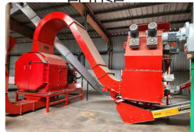
Démêleur, broyeur, filtre à écluse
